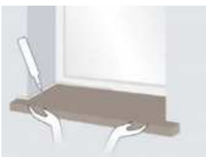
6_LEPLJENJE KLUPICE NA PODLOGU I ZAPTIVANJE MONTAŽNOM GIT MASOM
