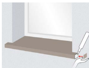
7_LEPLJENJE ZAVRŠETAKA NA KRAJEVE KLUPICA POMOĆU MONTAŽNOG LEPKA
