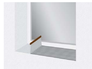
4_NANOŠENJE LEPKA ZA STIROPOR NA PODLOGU
